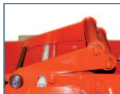
Schlaffseilschalter Slack-rope switch Détection de brin mou
