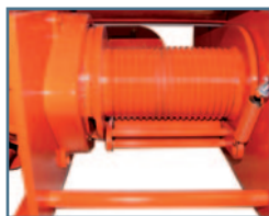
Seilandruckrolle Pressure roller Rouleau presse cable
