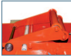
Schlaffseilschalter (3) Slack-rope switch (3) Détection de brin mou (3)
