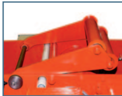
Schlaffseilswitch (3) Slack-rope switch (3) Détection de brin mou (3)
