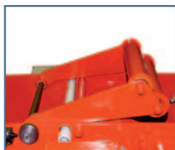
Schlaffseilschalter Slack-rope switch Détection de brin mou
